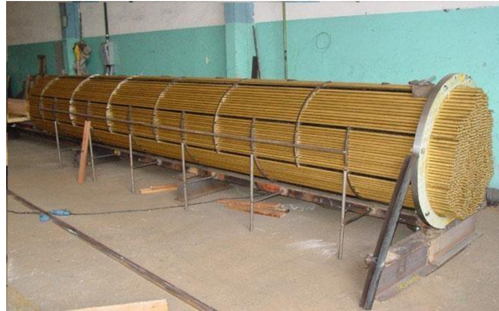
Fixe de caldeira Flamotubular com suas chicanas.
