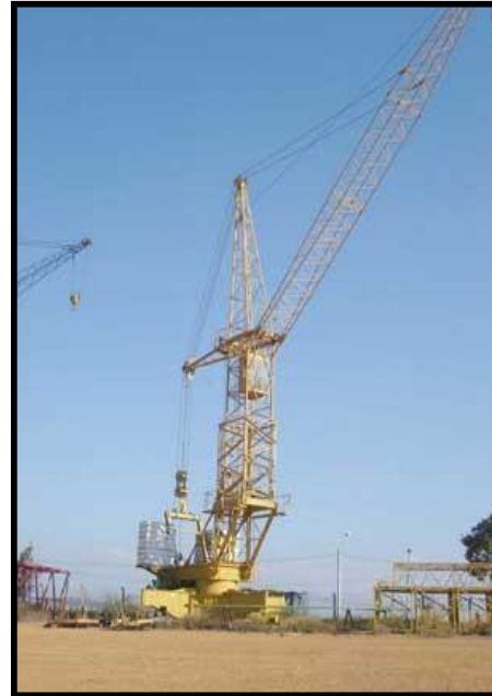
Figura 56: Guindaste sobre pedestal
