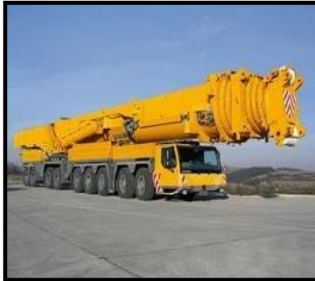
Figura 52: Guindaste hidráulico sobre caminhão
