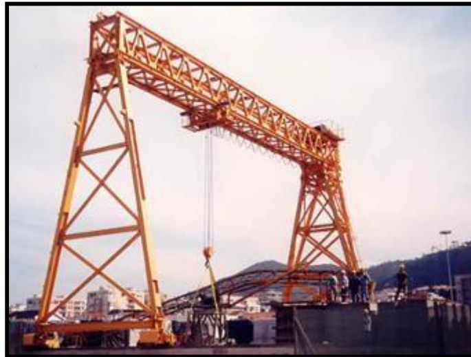
Figura 32: Pórtico de 30ton para pré-fabrico de antifers
