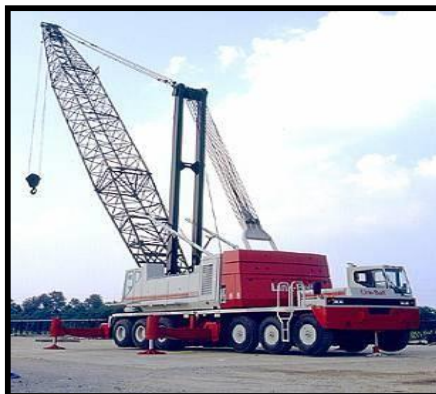
Figura 51: Guindaste sobre Caminhão com Lança Treliçada
