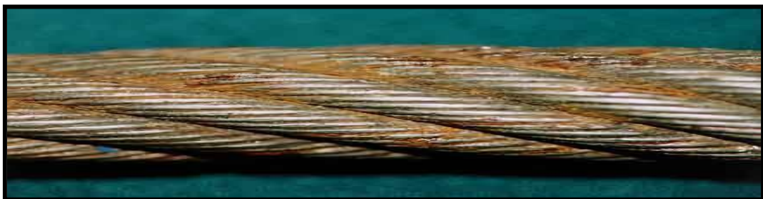
Figura 88: Cabo de aço com corrosão
