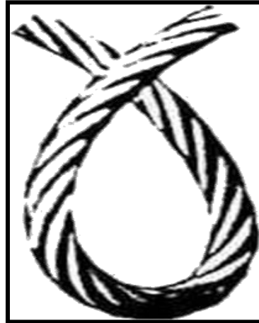
Figura 93: Cabo de aço com avaria
