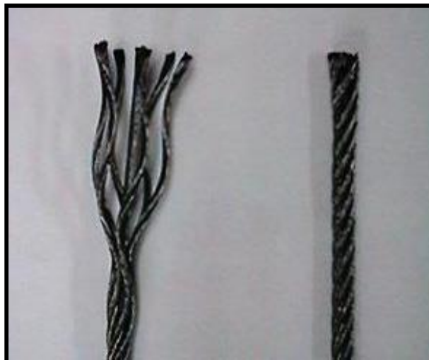
Figura 74: Cabo de aço com avaria
