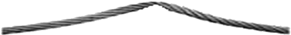
Figura 86: Cabo de aço com amassamento
