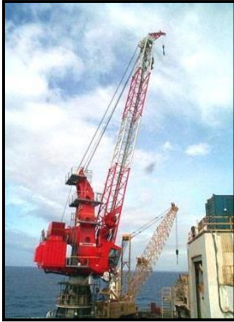
Figura 55: Guindaste sobre pedestal
